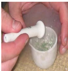
Рис. 15. Измельчение материала с применением жидкого азота
