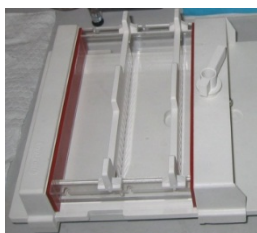
Рис. 24. Заливочный столик с гребенками для агарозного геля
