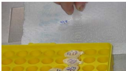
Рис. 20. Удаление остаточного количества промывочного раствора
