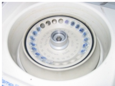
Рис. 18. Равномерное размещение пробирок в центрифуге
