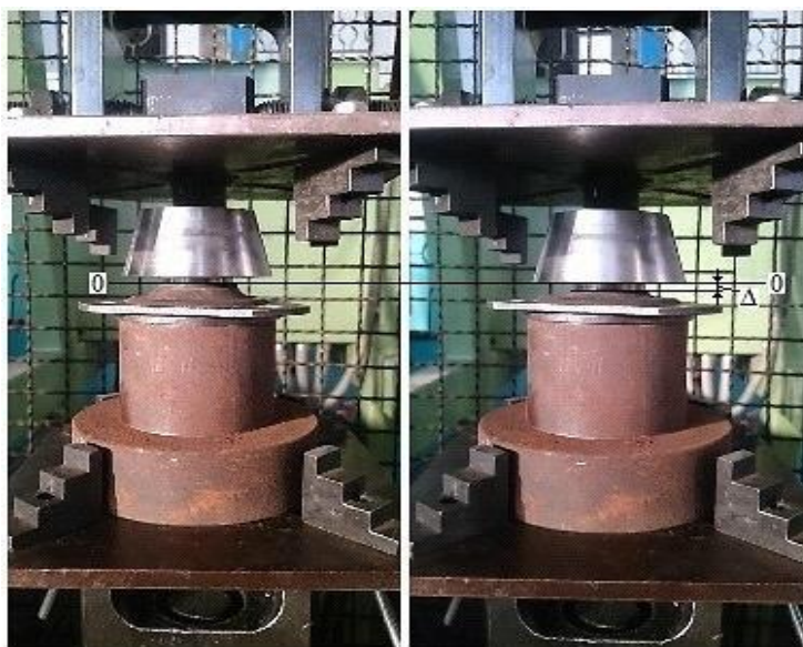
Рис. 2. Испытательная установка с компьютерным управлением VDA-1001K с установленным для испытаний виброизолятором кабины колесного трактора «Беларус-3022ДЦ.1»: \Delta – величина статической деформации виброизолятора
