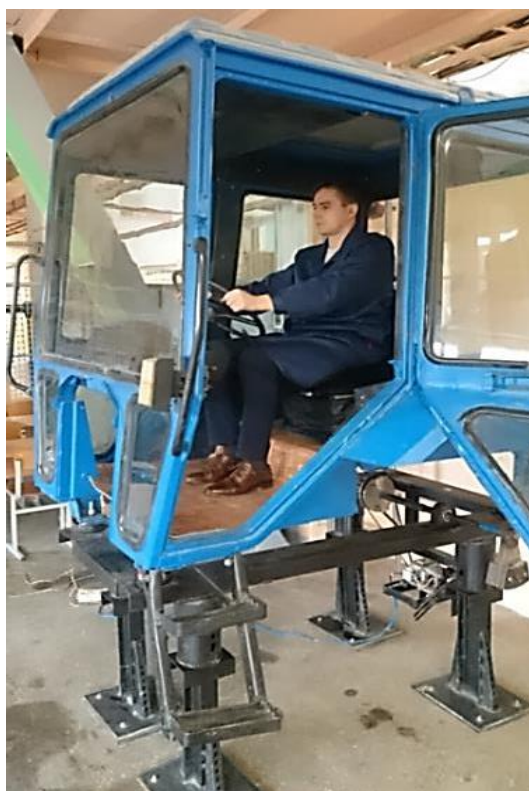
Рис. 1. Внешний вид стенда имитационных испытаний системы поддрессирования кабины колесного трактора МТЗ с моделированием возмущений
