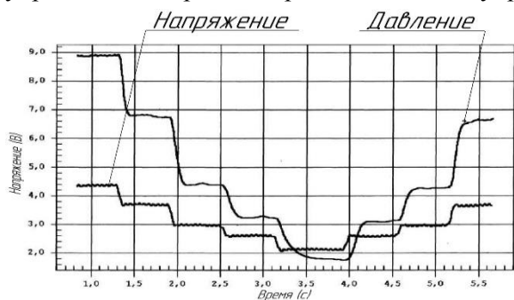
Рис. 4. График зависимости напряжения управления и давления в фрикционной муфте от времени при использовании наложения высокочастотной составляющей
