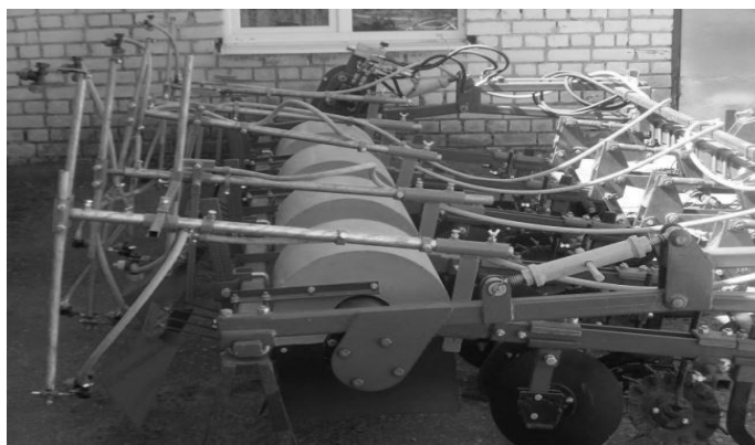
Рис. 5. Опрыскиватель с телескопическими секциями в составе агрегата для междурядной обработки АУ-М2 (вид сбоку)
