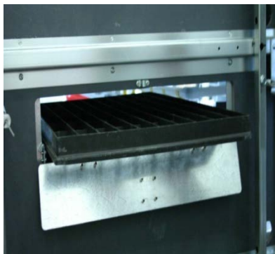
Рис. 2.2. Система транспортировки инкубационных лотков
