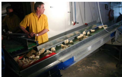
Рис. 2.9. Конвейер сбора птицы
