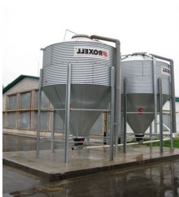
Рис. 1.20. Бункеры для хранения концентрированных кормов
