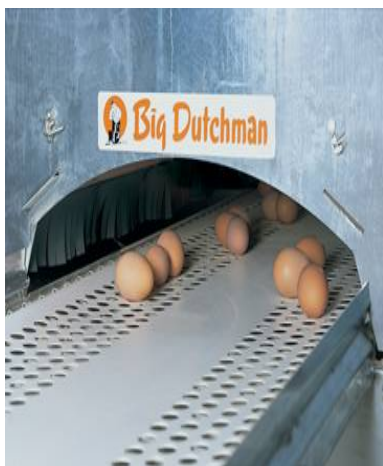
Рис. 1.14. Гнезда для автоматического сбора яиц
