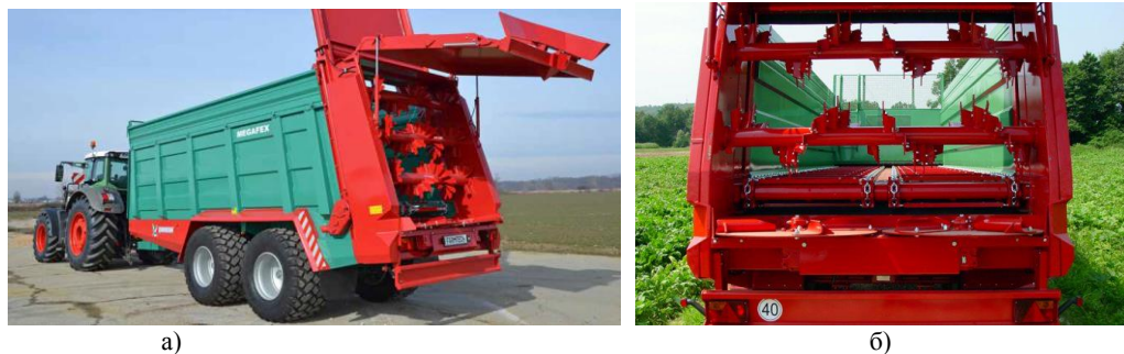
Рис. 3. Универсальный разбрасыватель MEGAFEX фирмы «FARMTECH»: а) общий вид; б) подающий транспортер и фрезерный агрегат
