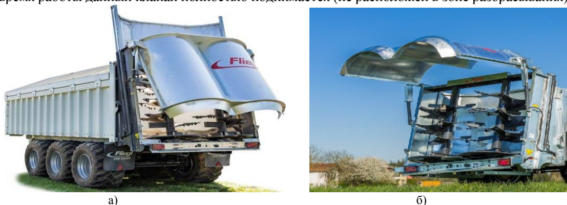
Рис. 4. Универсальный разбрасыватель ASW 373 «Tiger» фирмы «Fliegl»: а) общий вид; б) фрезерный агрегат с вертикальными рабочими органами
