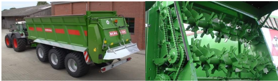
Рис. 2. Универсальный разбрасыватель TSW 7340S фирмы «BERGMANN»: а) общий вид; б) фрезерный агрегат
