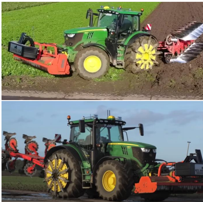
Рис. МТА John Deere 6195R met Stapwielen + 6 schaar Kuhn Vari Master с быстросъемными зацепами [8]
