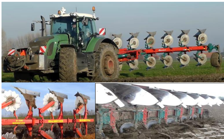
Рис. Пахотный МТА с установленными дисковыми ножами перед каждым корпусом оборотного плуга
