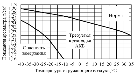
Рис. 7.4. Номограмма зависимости плотности электролита от температуры окружающего воздуха и разрядки аккумуляторной батареи
