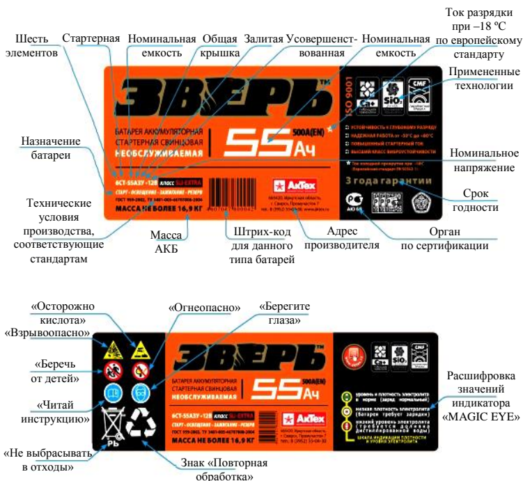
Рис. 7.1. Пример маркировки аккумуляторной батареи
