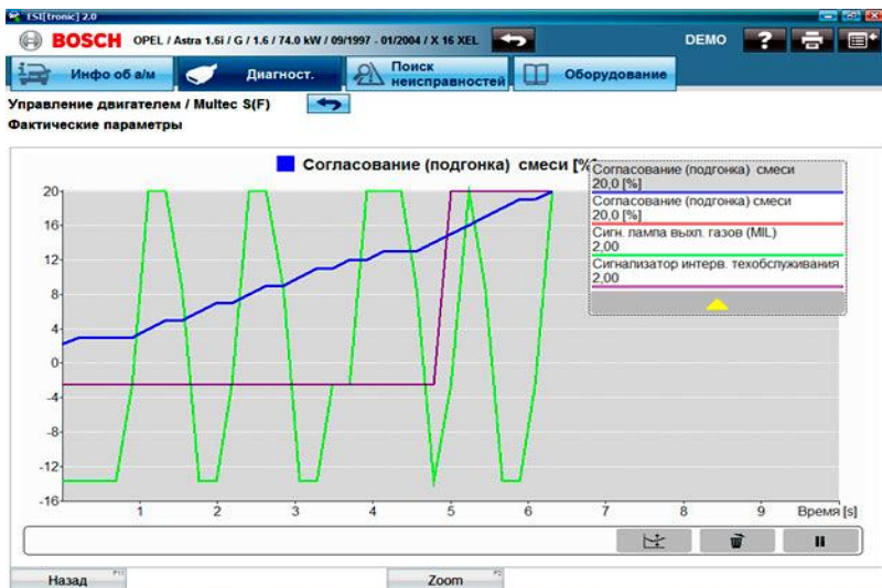
Рис. 4.19. Отображение измеряемых значений для выбранных фактических параметров в графическом виде
