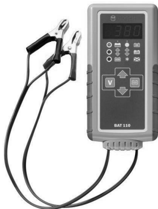
Рис. 7.7. Портативный тестер аккумуляторных батарей Bosch BAT 110
