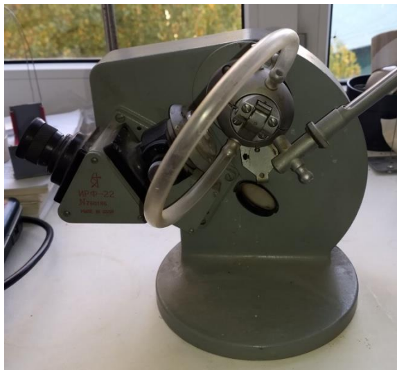
Рис. 1. Используемое оборудование – рефрактометр ИРФ-22
