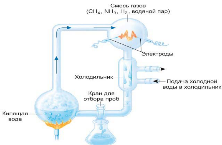
Рис. 7.1. Схема установки опыта С. Миллера и Г. Юри
