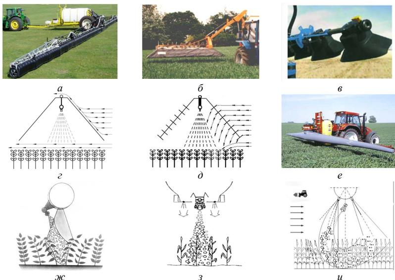
Рис. 1. Конструкции и схемы устройств защиты факела распыла штанговых опрыскивателей: *а* – ветрозащитные кожуха; *б*, *в* – ветрозащитные щитки; *г*, *д* – схемы движения воздушных потоков при использовании щитков и жалюзийной решетки; *е* – воздухораспределительная система; *ж* – схема принудительного осаждения капель воздушной струей; *з* – схема воздухоструйных защитных экранов (воздушные завесы); *и* – схема принудительного осаждения капель воздушными струями
