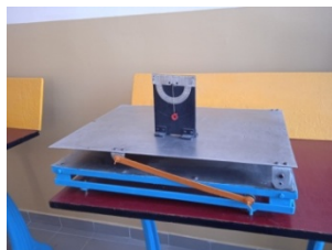
Рис. 2. Схема и общий вид прибора для определения коэффициента статического трения
