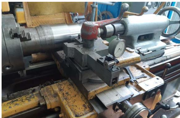
Рис. 1. Установка динамометра ДК-1 на токарный станок
