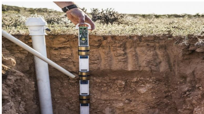
Рис. 1. Сенсорный датчик Sentek EnviroSCAN
