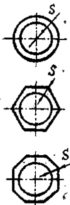
Рис. 3.1. Типы дренажных труб: круглые; шестигранные; восьмигранные
