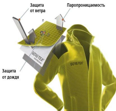
Рис. 3. Слои, из которых состоит ткань (мембранный материал)
