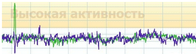
Рис. 2. Регистрация сочетания положительного пика двигательной активности с отрицательным пиком руминации и дальнейшим наблюдением за активностью и руминацией: а – системой «Майстар», б – системой «Heatime»
