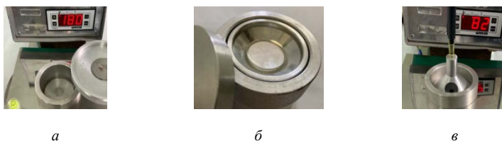
Рис. 1. Универсальный электротигель для определения: а – наличия и количества топлива; б – наличия и количества воды; в – моюще-диспергирующих свойств
