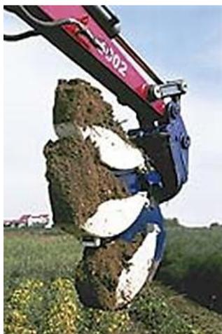
Рис. 1. Конструкция ковша для рытья узких траншей
