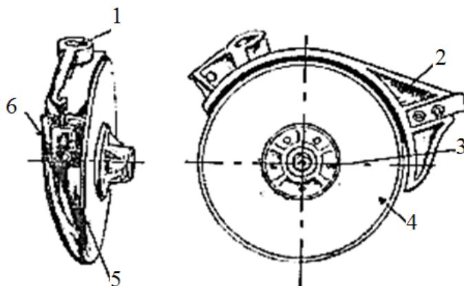
Рис. 1. Двухдисковый сошник с углом атаки дисков 9°:
