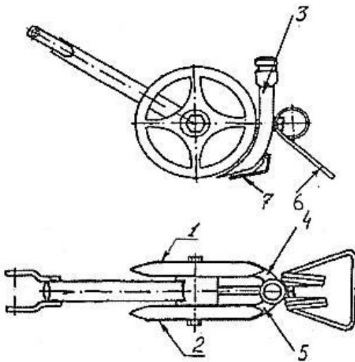
Рис. 3. Двухдисковый двухстрочный сошник:
