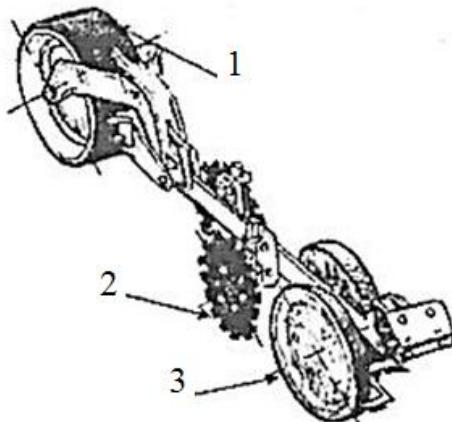
Рис. 8. Дисковые сошники в сочетании с бороздными колесами FARMFLEX и прикатывающим колесом сеялок EASYDRILL:
