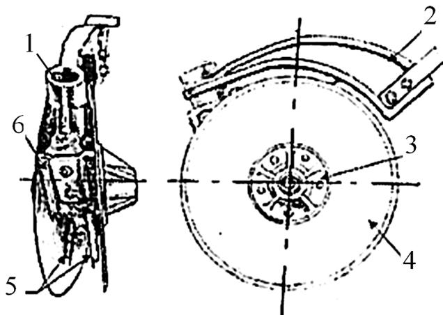
Рис. 2. Узкорядный двухдисковый сошник с углом атаки дисков  $18^\circ$ :
