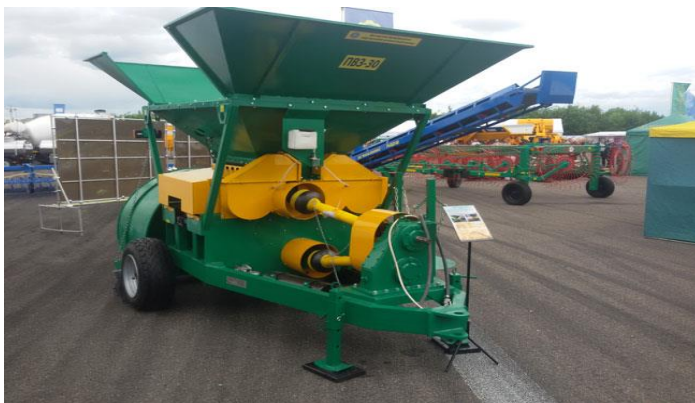
Рис. 4.2. Плющилка влажного зерна ПВ3-30
