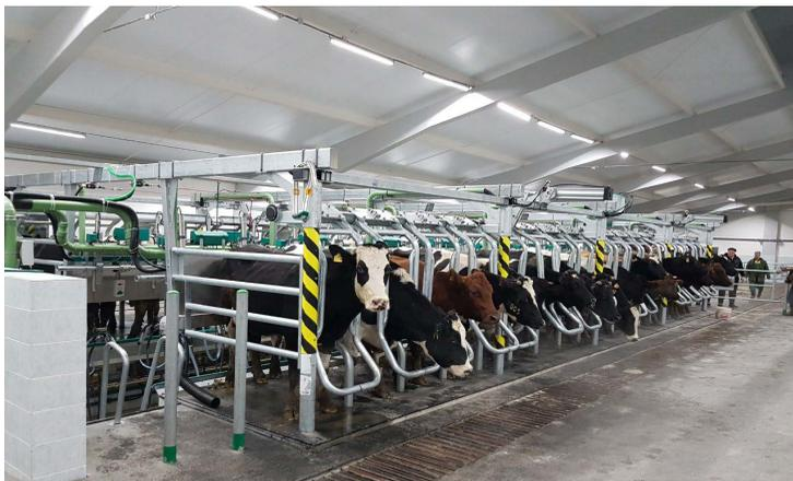
Рис. 34. Доильный зал «Параллель»
