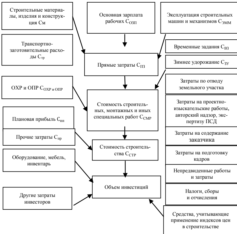
Рис. 3.1. Порядок формирования стоимости строительства
