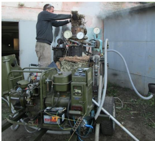
Рис. 1. Загрузка в газогенератор навоза КРС
