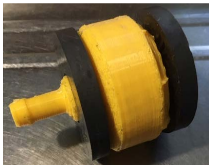
Рис. 1. Фильтр-омагничиватель ФО-1, изготовленный на 3D принтере Creatbot D600 Pro
