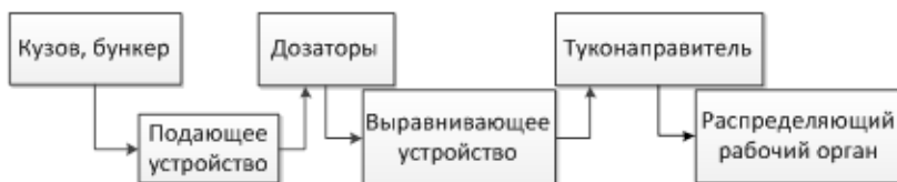
Рис. 2. Элементная схема машин для внесения удобрений
