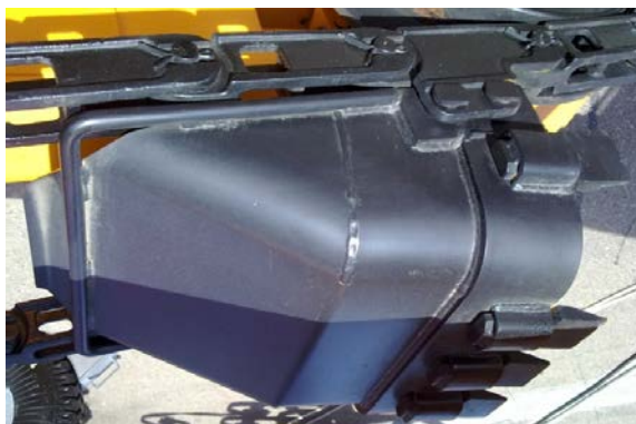
Рис. 2. Ковш экскаватора-дреноукладчика ЭТЦ-203
