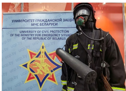
Рис. 3. «Установка для распыления твердых сыпучих материалов при ликвидации чрезвычайных ситуаций, связанных с разливом жидких агрессивных сред Silver Edge»
