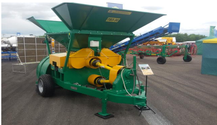
Рис. 4.2. Плющилка влажного зерна ПВ3-30
