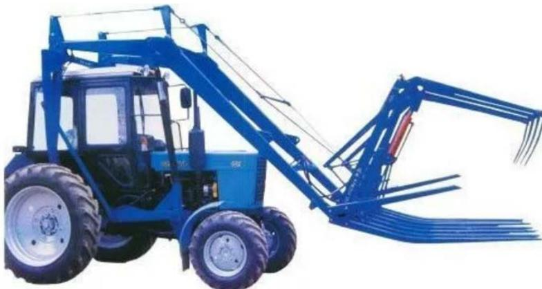
Рис. 3.5. Стогометатель-погрузчик навесной СНУ-550
