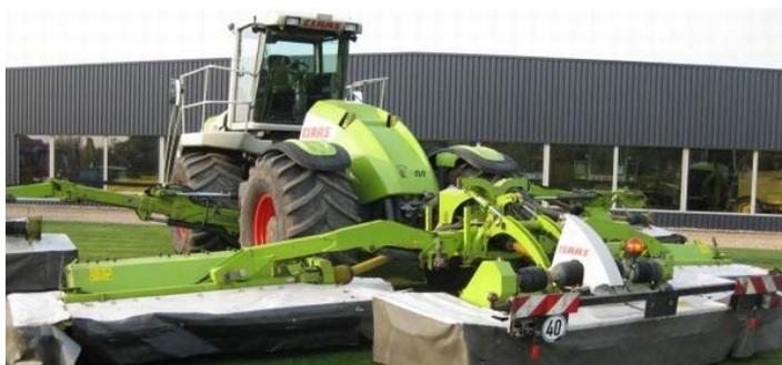
Рис. 1.10. Широкозахватная самоходная косилка Cougar 1400 фирмы Claas
