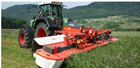
Рис. 1.9. Широкозахватная косилка-кондиционер FC 703 фирмы Kuhn (Франция)
