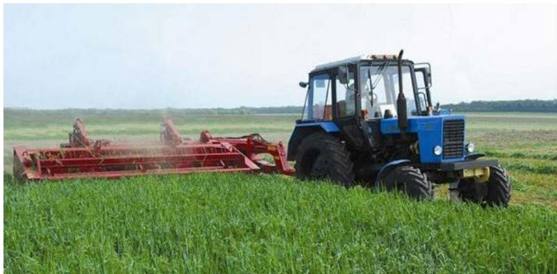
Рис. 1.18. Косилка-плющилка прицепная КПП-4,2 «ПАЛЕССЕ СТ42»
