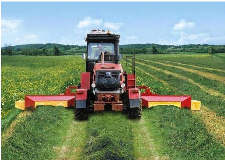
Рис. 1.16. Косилка-плющилка трехсекционная ротационная навесная КПр-9 «ПАЛЕССЕ СН90»
