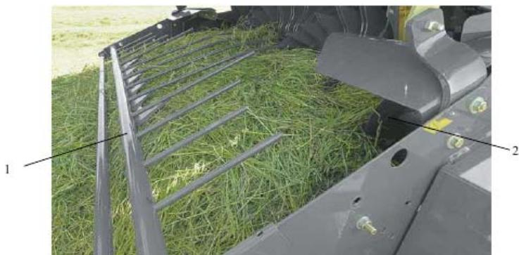
Рис. 3.2. Барабанный подборщик: 1 – прижимное устройство; 2 – винтовой конвейер
