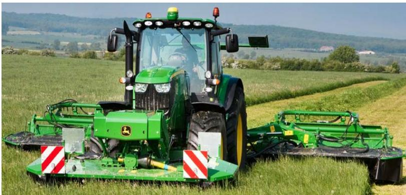
Рис. 1.14. Комбинированная широкозахватная косилка John Deere 381
