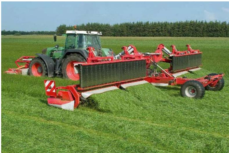
Рис. 1.15. Комбинированная широкозахватная косилка GXT 12005 SM фирмы JF-Stoll
