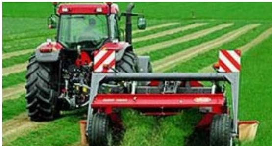
Рис. 1.13. Боковая косилка KD 210 фирмы Kverneland
