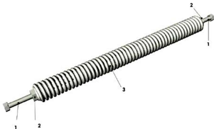
Рис. 2.12. Пружина: 1 – тяги; 2 – пробки; 3 – пружина
