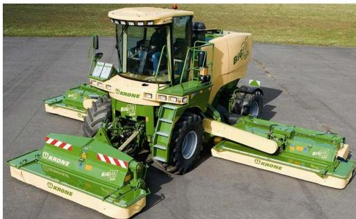
Рис. 1.12. Самоходная косилка Big M II фирмы Krone
