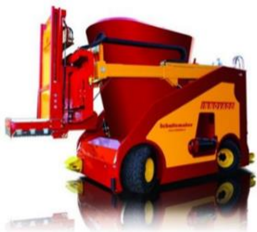
Рис. 3. Автоматизированные координатные смесители-раздатчики кормов: а – Innovado (Schuitemaker Machines B. V.); б – Vector (Lely)
