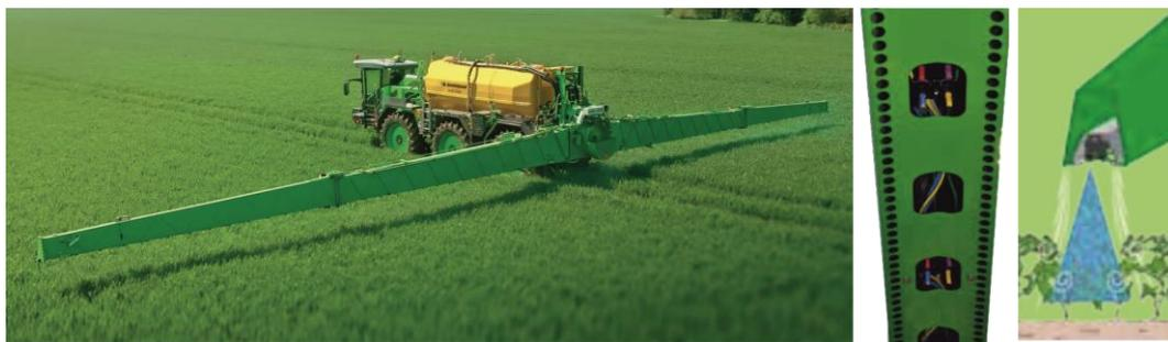
Рис. 5. Ветрозащитные устройства активного действия
