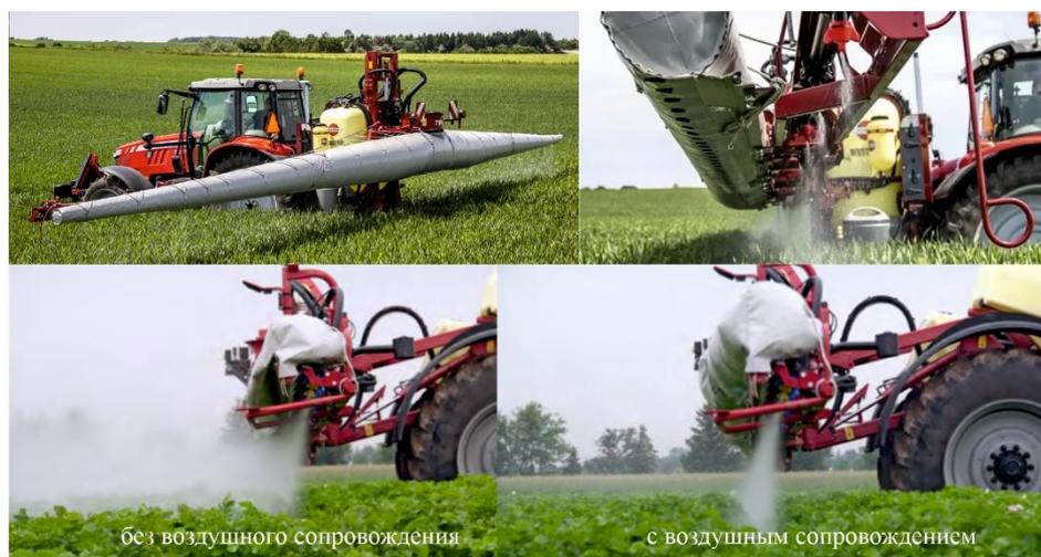
Рис. 4. Ветрозащитные устройства активного действия
