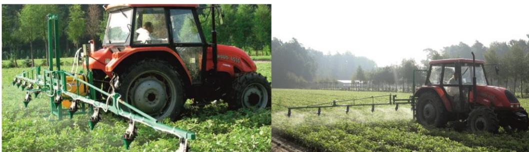
Рис. 7. Опрыскиватель Micromax с роторным распылителем [16]
