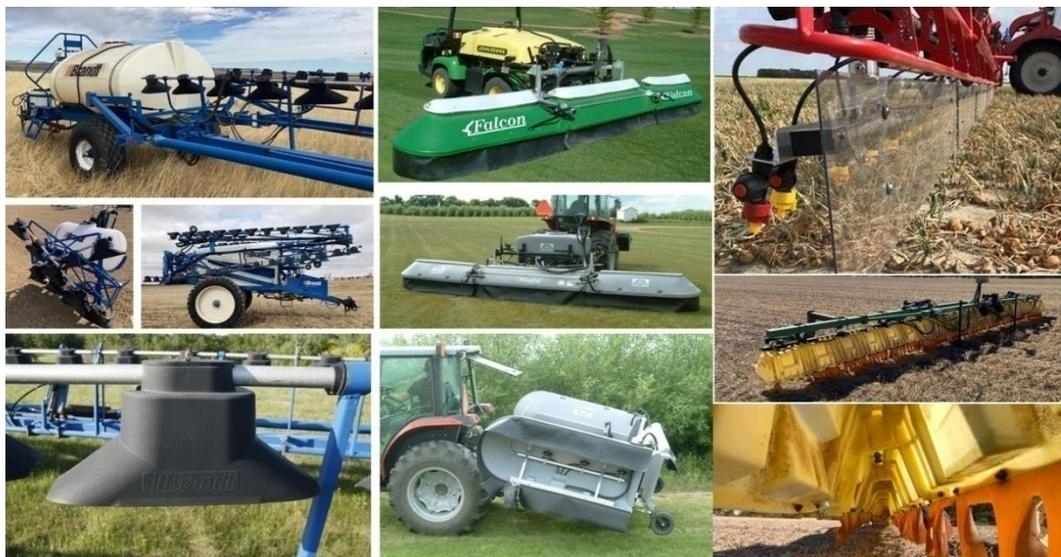
Рис. 3. Опрыскиватели с ветрозащитными устройствами пассивного действия
