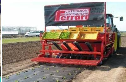
Рис. 18.8. Многофункциональная машина для посадки земляники
