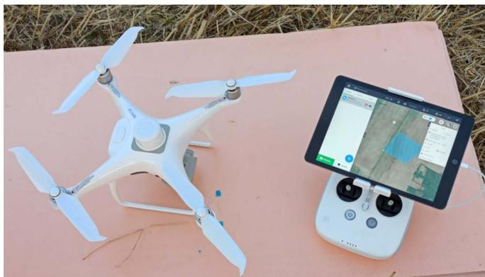
Рис. 1. Квадрокоптер с мультиспектральной камерой DJI Phantom 4 Multispectral
