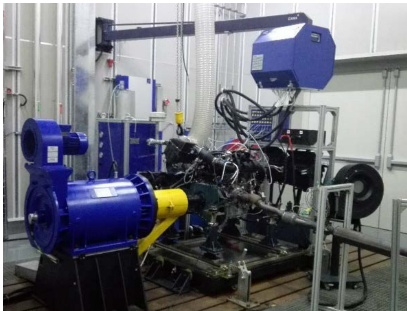
Рис. 1. Стенд для испытаний ДВС
