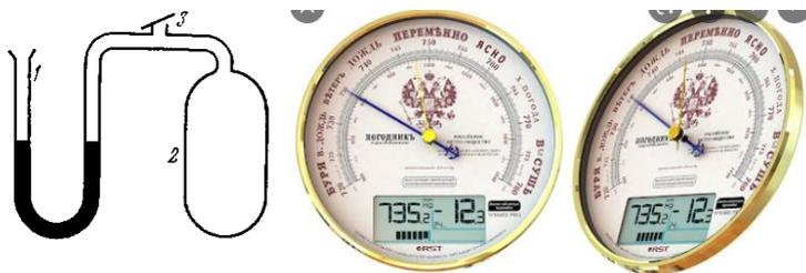
Рис. 2.13. Схема статоскопа: 1 – манометрическая трубка; 2 – баллон; 3 – клапан
