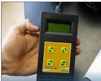
Рис. 8.7. Включение прибора МГ-44
