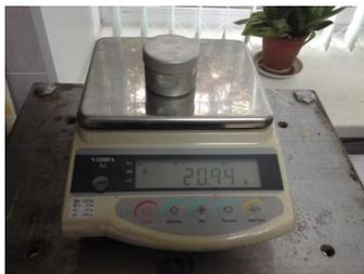
Рис. 8.2. Взвешивание пустого стаканчика и крышки для определения массы
