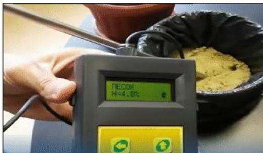
Рис. 8.11. Влажность песка, измеренная прибором МГ-44
