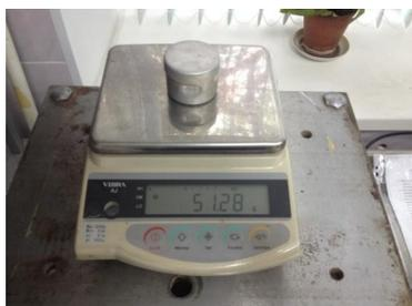
Рис. 8.3. Взвешивание стаканчика с грунтом и крышкой
