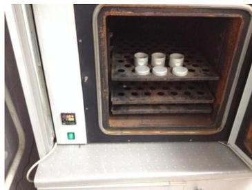
Рис. 8.4. Стаканчики с грунтом и крышками в сушильном шкафу
