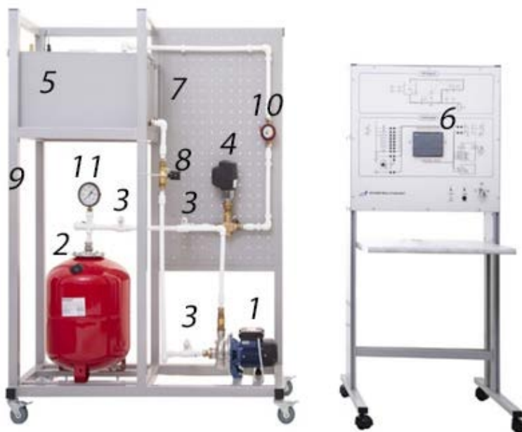
Рис. 3.9. Общий вид лабораторного стенда: 1 – насосная установка, в состав которой входят центробежный насос (Н) и однофазный приводной электродвигатель; 2 – пневматический бак (ПБ); 3 – кран шаровый (В1...В3); 4 – сервопривод, контролирующий открытие и закрытие задвижки по командам логического программируемого контроллера ПЛК S7-1200 (СВ); 5 – гидробак верхний (Б2); 6 – реле уровня герконового типа (ДУГ); 7 – указатель уровня воды в верхнем гидробаке (УУ); 8 – клапан электромагнитный, выполняющий функции обратного клапана (КЭМ); 9 – рама стенда; 10 – импульсный расходомер (РА); 11 – манометр
