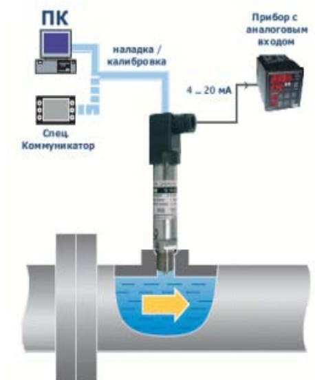
Рис. 4.4. Место установки датчиков давления на трубопроводе
