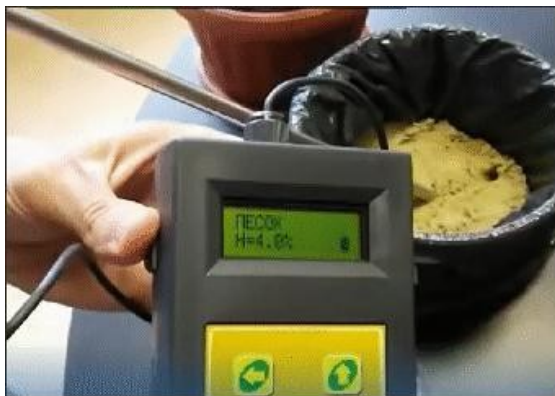
Рис. 7.12. Влажность песка, измеренная прибором МГ-44
