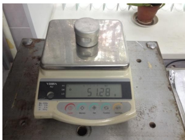
Рис. 7.3. Взвешивание стаканчика с грунтом и крышкой
