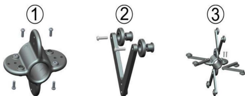
Рис. 11.6. Последовательность сборки и установки направляющих
