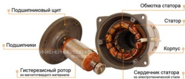
Рис. 8.14. Конструкция синхронного гистерезисного двигателя
