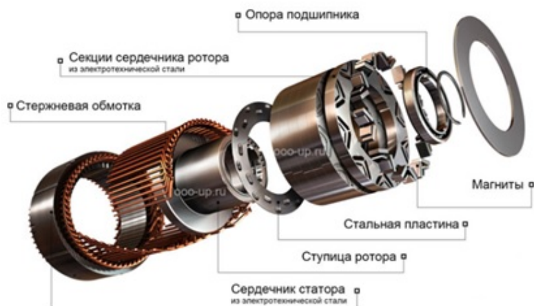
Рис. 8.7. Синхронный электродвигатель со встроенными постоянными магнитами
