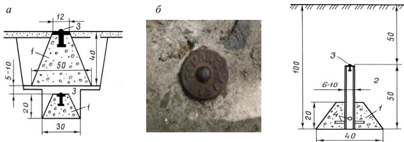
Рис. 2.2. Центры пунктов триангуляции, полигонометрии, трилатерации 1-го и 2-го разрядов и полигонометрии 4-го класса: а – тип 5 геодезической разбивки; б – тип 6 геодезической разбивки; 1 – бетонные монолиты в виде усеченной четырехгранной пирамиды; 2 – металлическая или асбестоцементная труба; 3 – марки центров; 4 – металлические стержни. Размеры даны в сантиметрах
