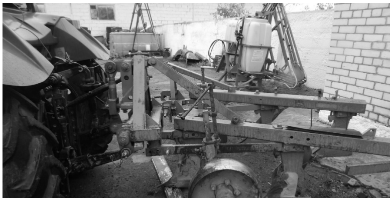
Рис. 3.2. Трактор «Беларус-922» с плугом ПЛН-3-35
