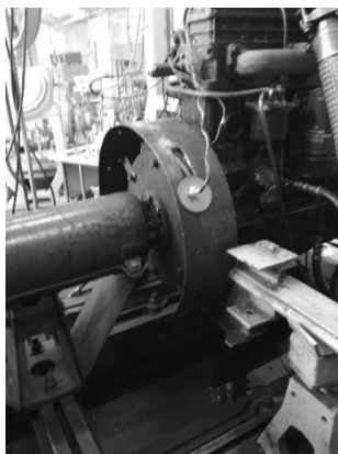
Рис. 3.6. Датчик отметки ВМТ
