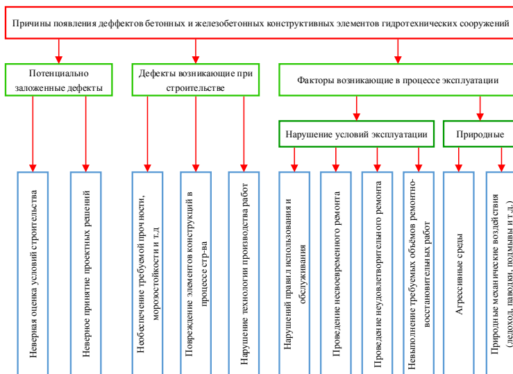
Рис. 1. Причины появления дефектов бетонных и железобетонных конструктивных элементов гидротехнических сооружений, расположенных на мелиоративных системах
