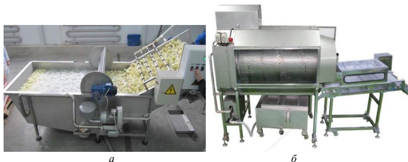
Рис. 5. Моечные машины: а – вентиляторная; б – барабанная
