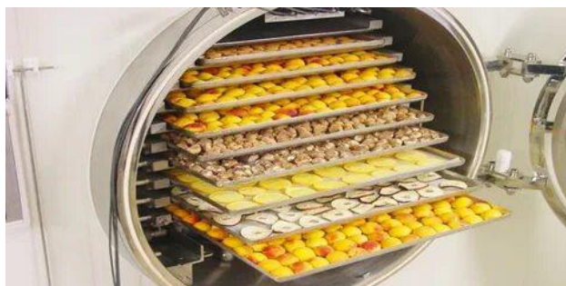
Рис. 15. Типы сушилок: а – вальцовая; б – сублимационная
