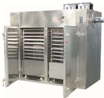
Рис. 14. Типы сушилок: a – шкафная; б – ленточная
