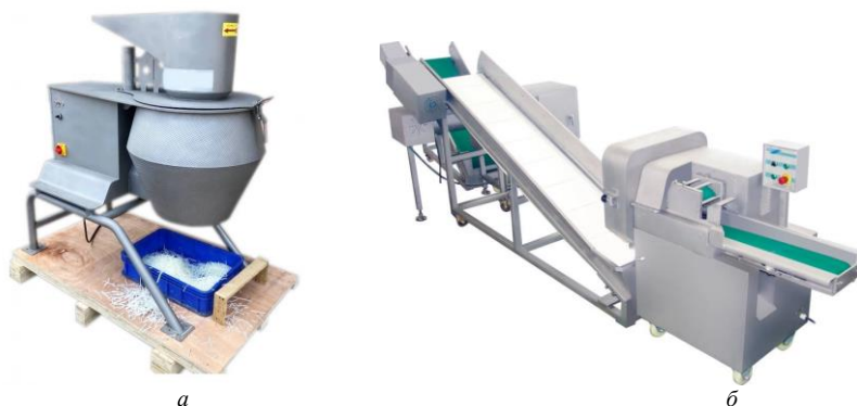
Рис. 8. Овощерезки: а – DVC 160 – машина для переработки овощей и зелени, а также корнеплодов; б – овощерезательная машина QC 200
