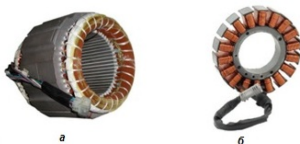
Рис. 8.10. Статоры синхронного электродвигателя с постоянными магнитами: a – с распределенной обмоткой; б – с сосредоточенной обмоткой
