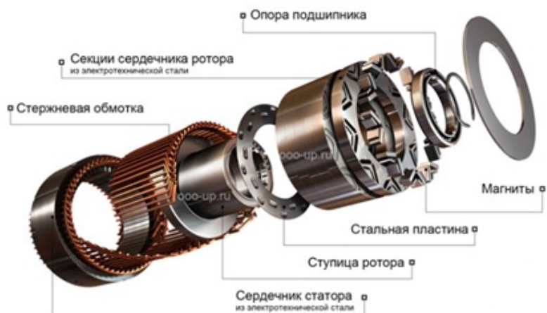
Рис. 8.7. Синхронный электродвигатель со встроенными постоянными магнитами
