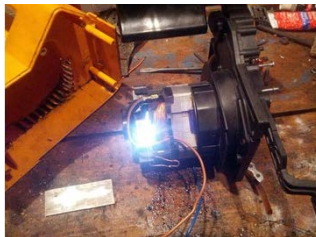
Рис. 9.20. Круговой огонь на коллекторе
