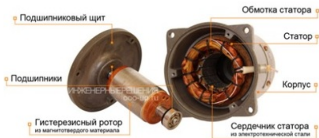
Рис. 8.14. Конструкция синхронного гистерезисного двигателя
