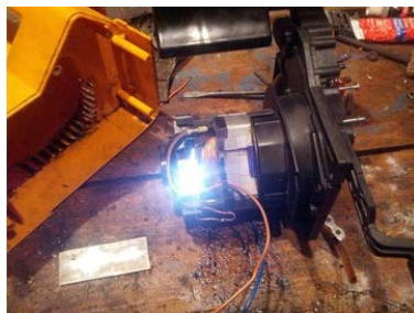
Рис. 4.20. Круговой огонь на коллекторе
