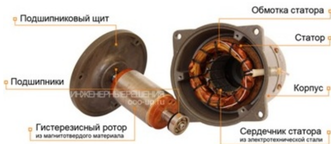
Рис. 3.14. Синхронный гистерезисный двигатель
