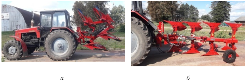
Рис. 2. Агрегат с плугом ПОНС-4-40 в транспортном ( а ) и рабочем ( б ) положениях
