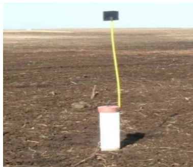
Рис. 3.2. Наблюдательный колодец для наблюдений за уровнем грунтовых вод на мелиоративной системе
