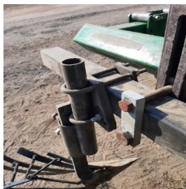
Рис. 3. Крепление предплужника к тяговой установке: – лемешной (пластинчатый) – дисковый
