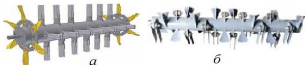
Рис. 2. Аэровоздушные лопасти: – торцевые; – продольные
