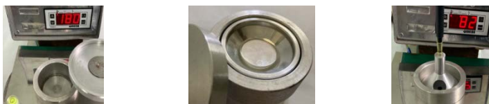
Рис. 1. Универсальный электротигель для определения: – наличия и количества топлива; – наличия и количества воды; – моюще-диспергирующих свойств
