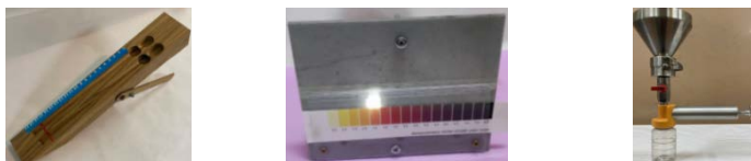
Рис. 2. Приспособления и оборудование для оценки показателей моторного масла: – компаратор для определения изменения вязкости; – компаратор колориметрии для определения загрязненности сажей; – установка патч-тестирования для оценки общей загрязненности механическими примесями
