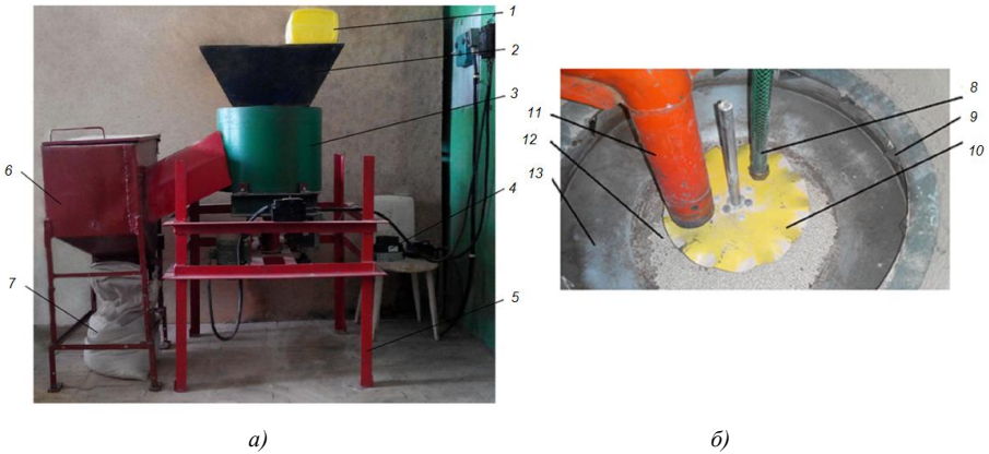
а ) – общий вид экспериментальной установки; б ) – общий вид камеры смешивания; 1 – резервуар жидких компонентов; 2 – бункер-дозатор сухих компонентов с раздельной камерой для семян; 3 – камера смешивания дражиратора; 4 – частотный преобразователь; 5 – рама; 6 – выгрузной бункер; 7 – мешок с обработанными семенами; 8 – трубопровод подачи жидких компонентов; 9 – лопастной отражатель; 10 – дисковый распылитель; 11 – трубопровод подачи сухих компонентов; 12 – семенное драже; 13 – дно дражиратора.
