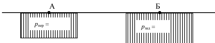
Рис. 13.14. Типичный вид эпюры давления гусениц на грунт четырехгусеничной машины
